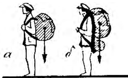
Рисунок 2 – Конструкция самодельного туристского рюкзака с «противооткидами»
